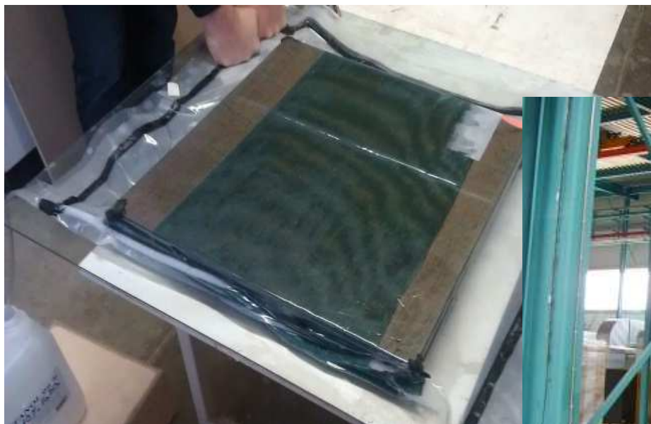
Slika 7: Posnetek pri pripravi izdelka - plošče z vakuumsko infuzijo.
