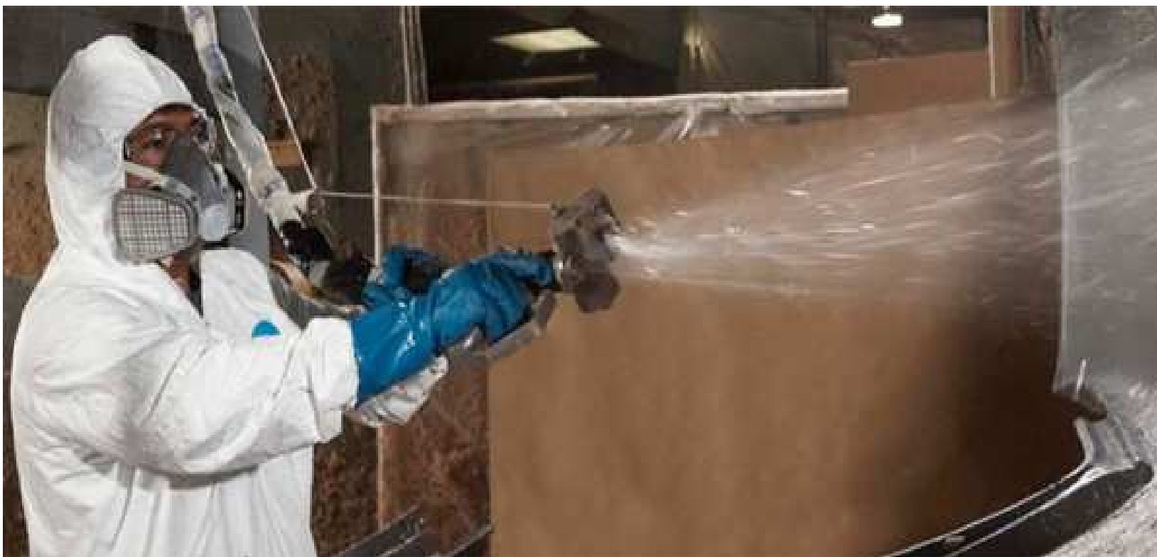
Slika 13: Posnetek laminacije s pištolo na sekance.
