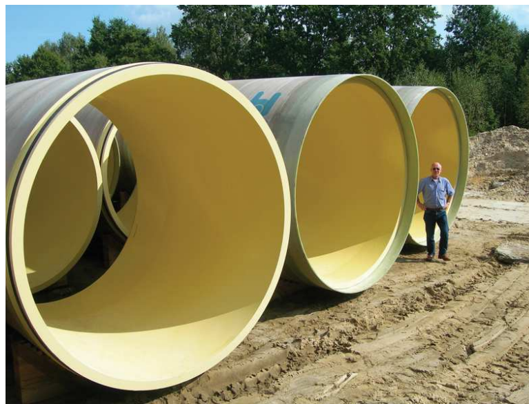
Slika 10: Posnetek cevi narejenih s tehnologijo navijanja.
