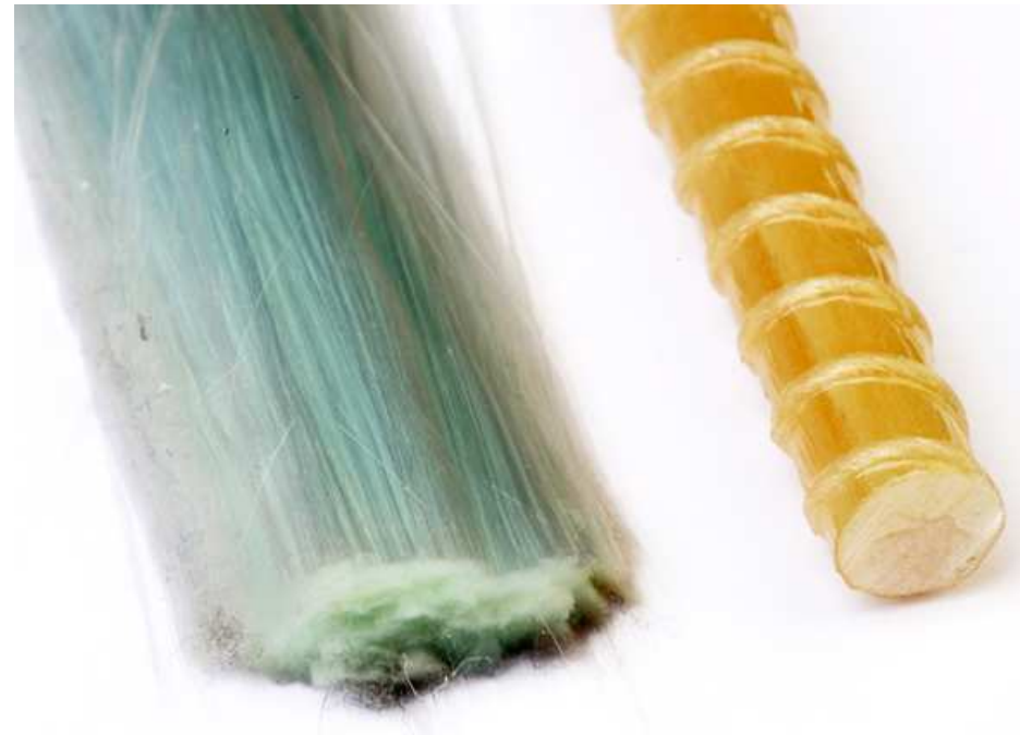
Slika 5: Desno - steklena ojačitvena vlakna, iz stekloplastične armirne palice (levo).
