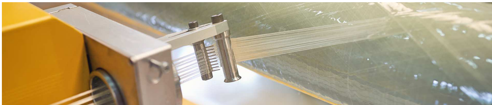
Slika 10: Posnetek navijanja vlaken.
